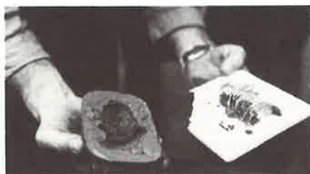
Så här ser formen och avgjutningen från den ut. Formen är delvis smält, har blivit litet lös i kanterna.
