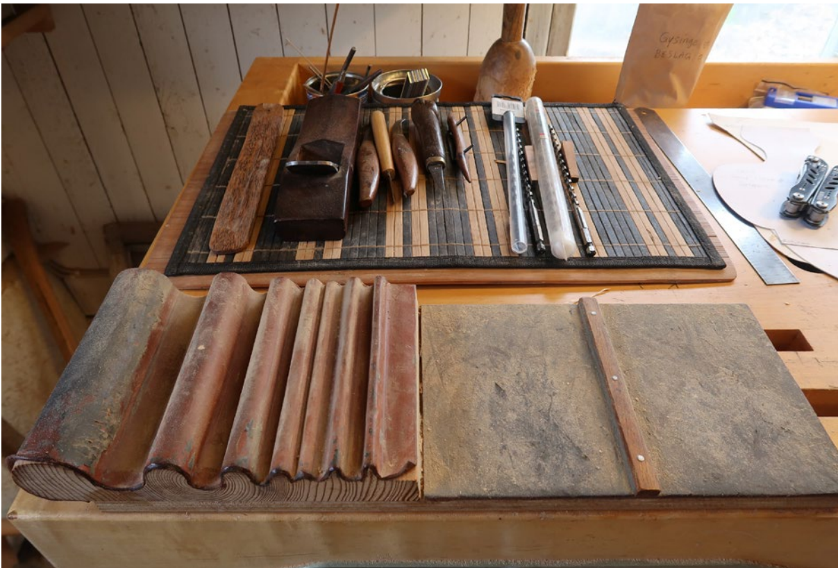
Profilerat och läderklätt brätte med slippasta för strigling av eggverktyg.
