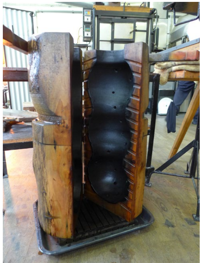
Innan träformen ska börja användas i hyttan så bränns den ur, dvs att man bränner av formens yta så att den förkolnar och därmed förseglas. Foto: Gunnar Englund.
