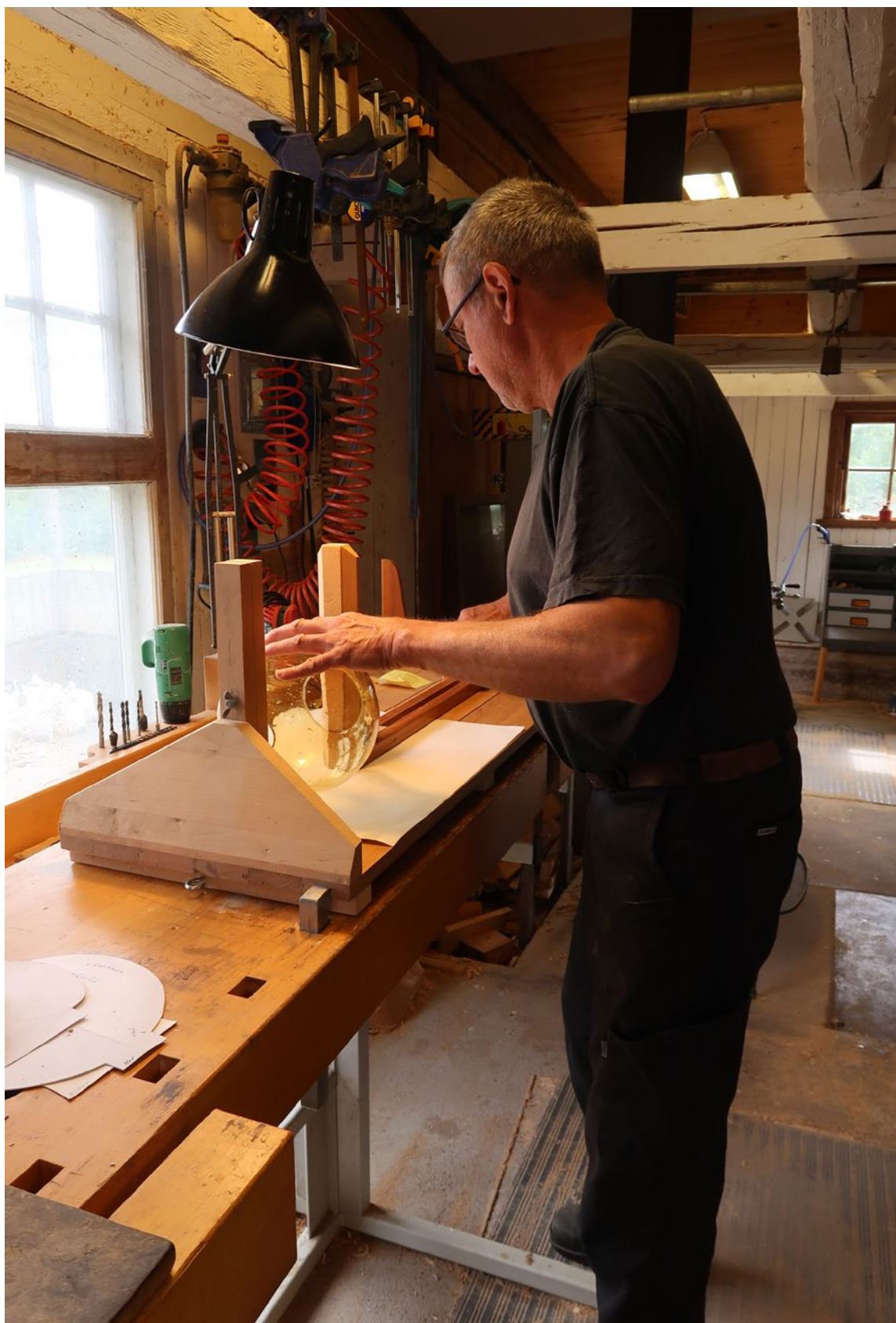
I "Hästen" spänns glasföremålet fast för att kunna ritas av exakt.
