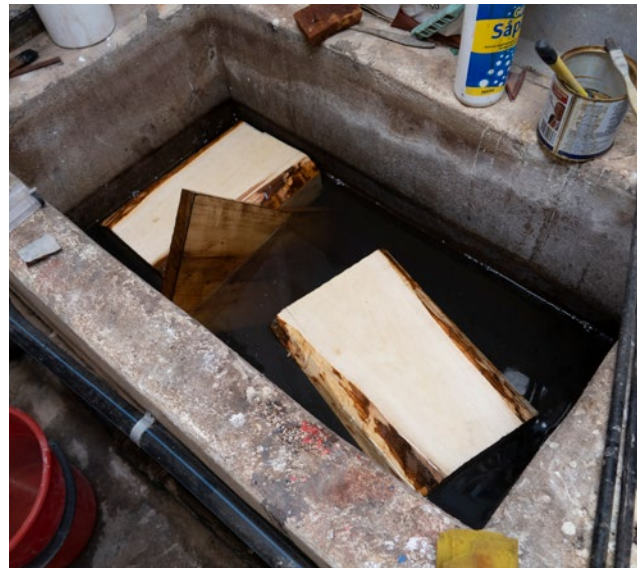
I det gamla mjölkkrummet används ett kar för att blötlägga formämnen så att de inte ska spricka.
