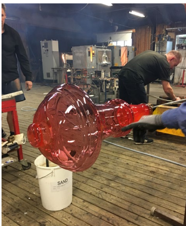
Bilderna föreställer hur Micke Johansson, Svante Decker, Lars Axelsson och Magnus Carlsson från teamet på Bergdala glasbruk blåser ett armaturglas i form av en kristallkrona. Lägga märke till ångan som bildas vid blåsningen. Den är nyckeln till den oöverträffande lyster i ytan hos ett glas blåst i träform. Hemligheten är att glaset aldrig nuddar själva formen, utan istället stoppas upp av ett tunt lager ånga. Formen är tillverkad i Gunnar Englunds verkstad i Örsjö. Designer är Anna Berglund. Liknande kronor fast större hänger som offentlig utsmyckning på Lexhuset i Bryssel. Foto: Anna Berglund.
