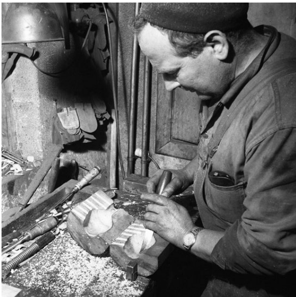
En träform som huggits ut för hand med en skölp renskärs med kniv. Bild från 1950-talet. Vinkeln på luftspåren antyder att formen är till liten flaska. Foto: Jan-Erik Anderbjörk, Smålands museum.
