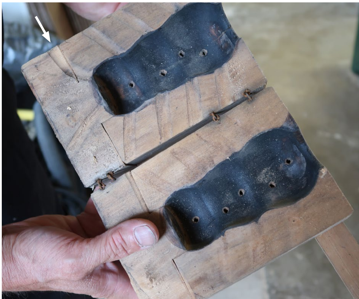
Gunnar visar en färdig form med lufthål i bägge halvor och luftspår, som görs i den ena formhalvan (se pil).
