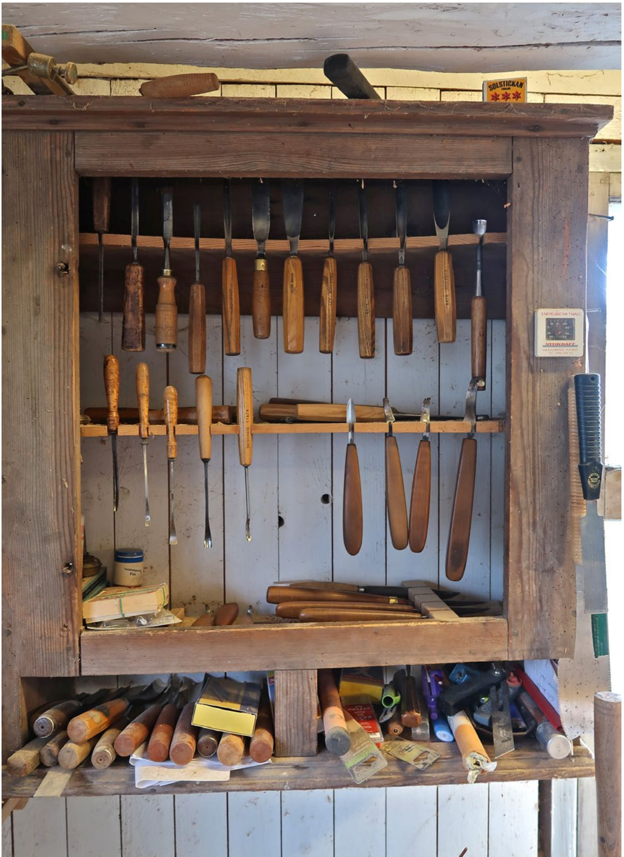
Skåp med olika skölpar, skedkrokar och knivar för renskärning av formarna.
