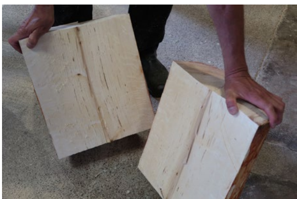
Gunnar delar ämnet i två lika stora delar, med hjälp av cirkelsågen.
