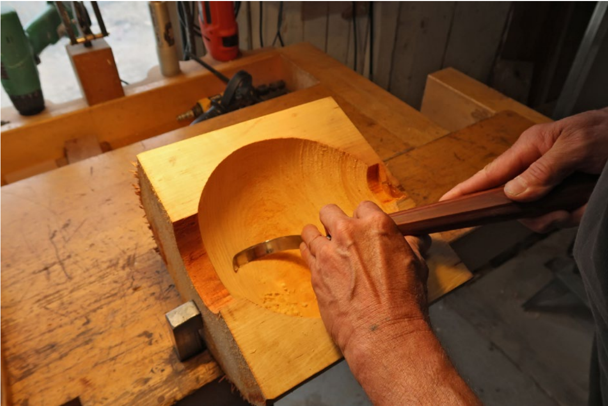
Gunnar jämnar till ytan med en böjd handsmidd krok. Arbetet kräver lugn och tålamod och är en viktig, meditativ, del av yrkesskickligheten.
