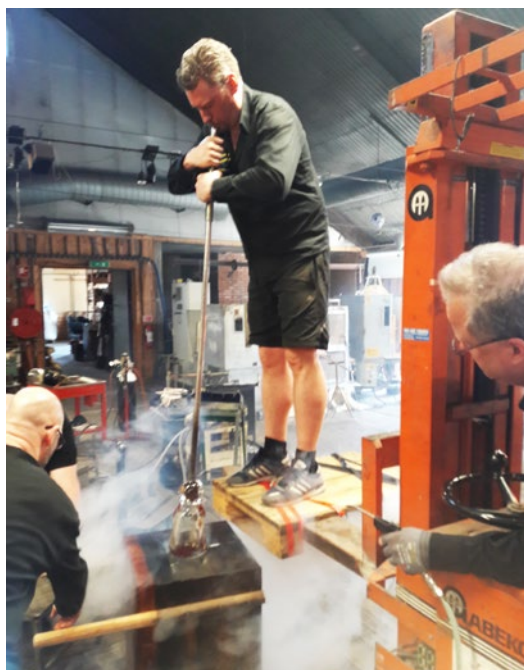
Samma form "in action" i glashyttan. En tuff match för Lars Axelsson på Bergdalahyttan, som måste ha hjälp av hela styrkan för att praktiskt klara av att blåsa de stora vaserna. Bland annat med att hissas upp (och sedermera ner) med en truck under processen. Foto: Thomas Jacobsson.
