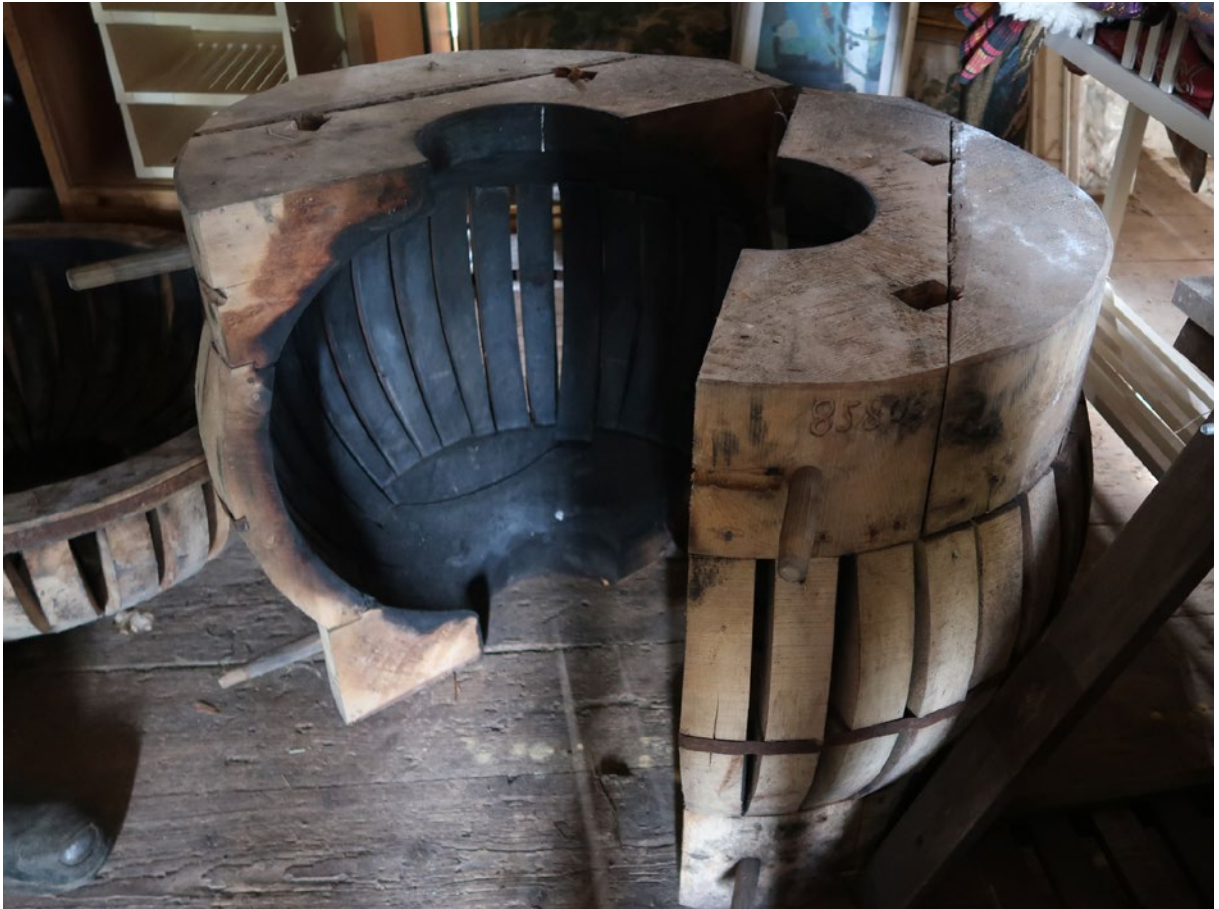
Spjälformar eller ribbformar användes förr för att blåsa riktig stora glaskupor. Dessa formar tillhör Pukeberg.
