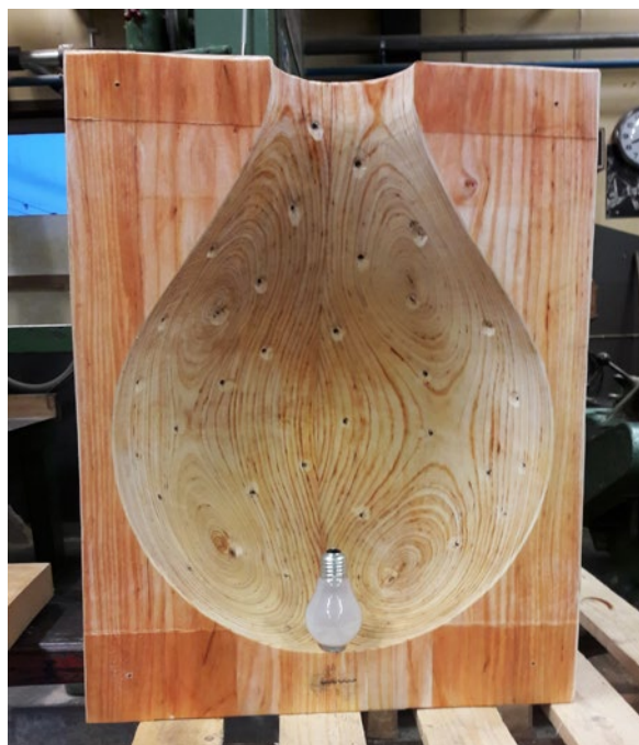
Den färdigfrästa träformen – ena halvan – innan montering. Formens invändiga mått är totalt 600 mm hög och 470 mm på diametern. Foto: Thomas Jacobsson.
