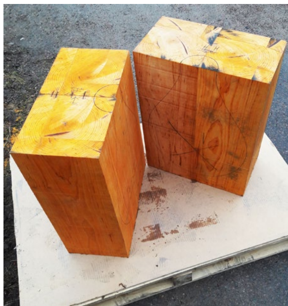
Förberett och blockat träämne för det som ska bli en stor form till Filippa K. Foto: Thomas Jacobsson.
