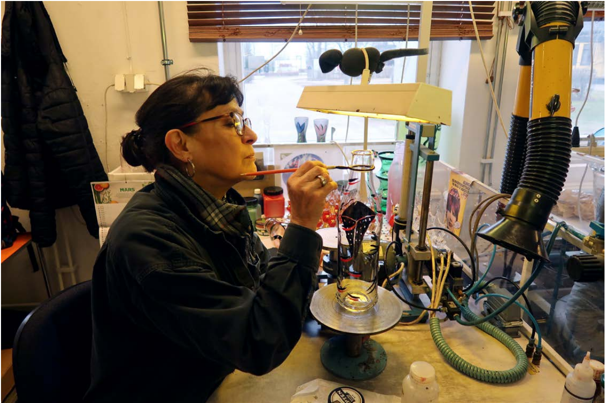
Målning med pensel på fri hand. Glaset står på en kavalett som kan snurras, så att glasmålaren kan komma åt att måla runt om hela glaset.
