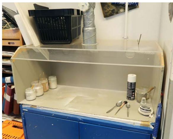
Högtempfärger av ädelmetaller målas i dragskåp.
