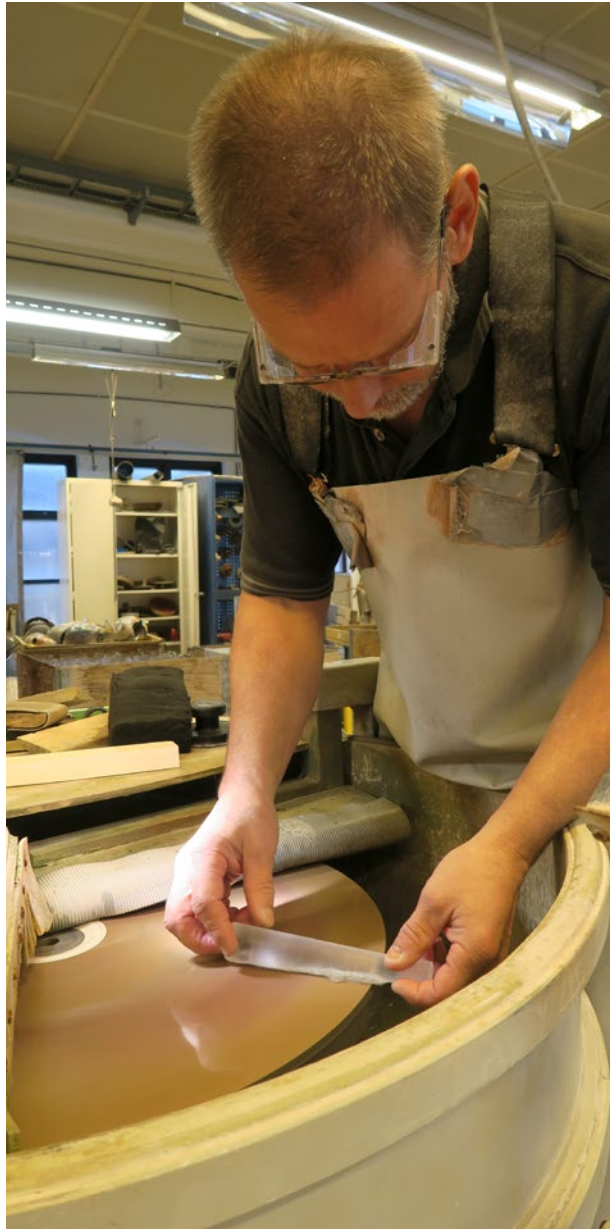
Anders visar här en typ av polering som inledningsvis används på glasklubbans handtag.
