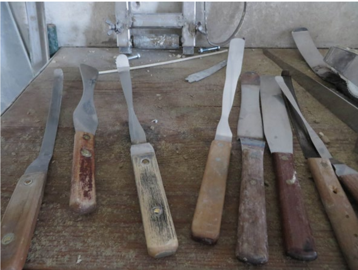
En kniv, eller allra helst "mormors gamla stekspade" i svenskt stål, används slutligen för att putsa till utsidan och trycka hål på bubblor. Efter flera års användning slits stekspadarna på ett karaktäristiskt vis.
