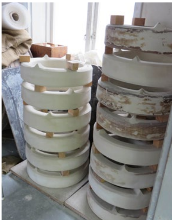
Ringarna behöver inte vila i fukt-kammaren, utan kan torka direkt i degelkammaren, innan de får vila på vinden tillsammans med deglarna.
