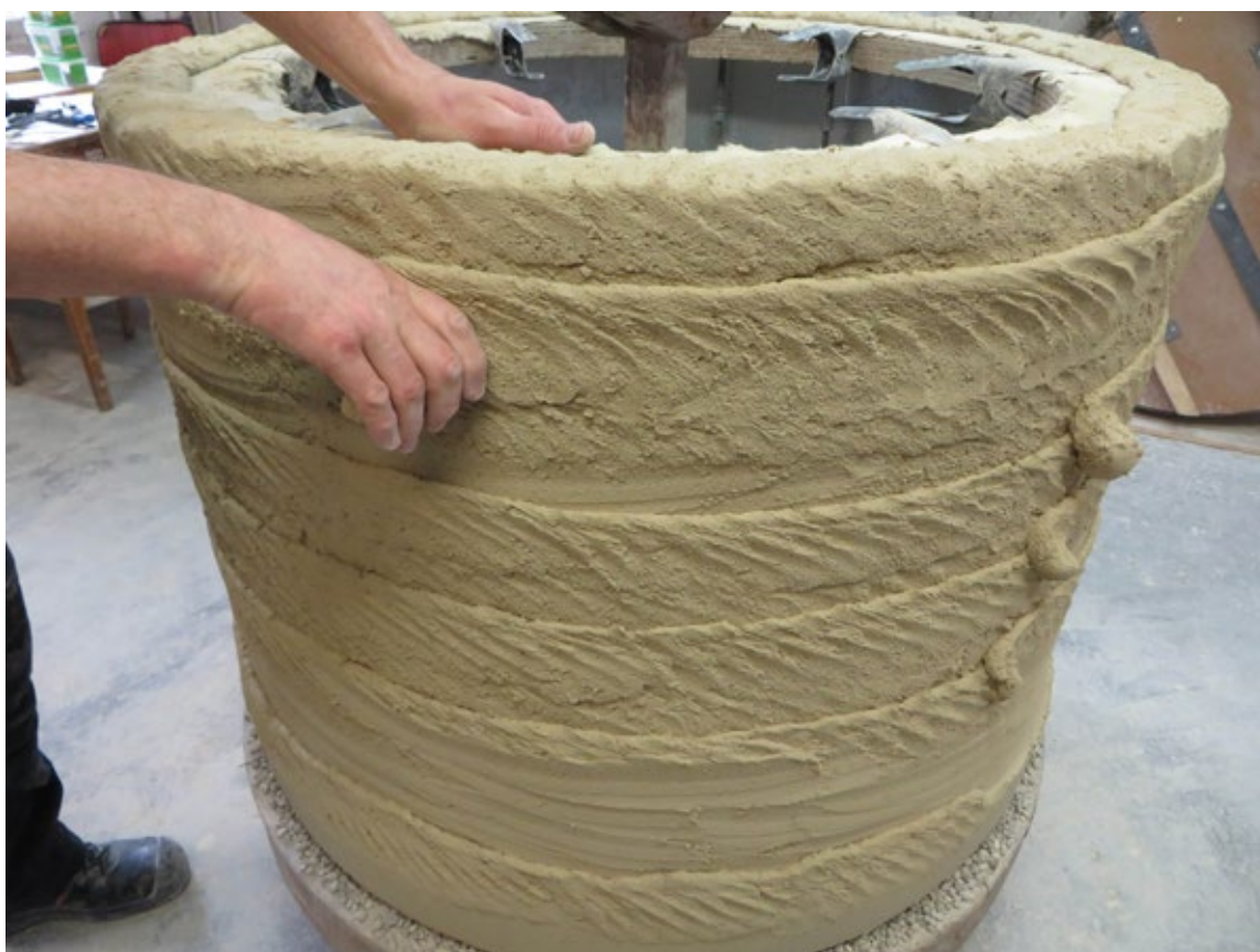
Peter Meinking visar hur en lagom bit lera från lerklumpen i mitten används. Leran ligger på en piedestal i mitten för att vara nära till hands. Leran slås och trycks in i degelns vägg, enligt en engelsk metod.
