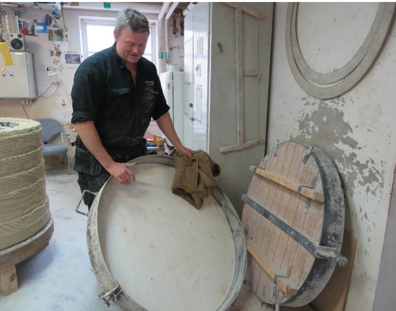
Peter Meinking visar den runda form som används för degelns botten. På skåpet i bakgrunden hänger trådsågen.
