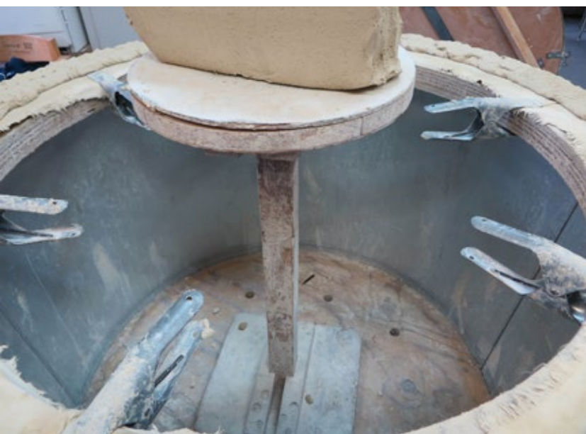
Formen på insidan tas bort när degeln tio lager är klara.
