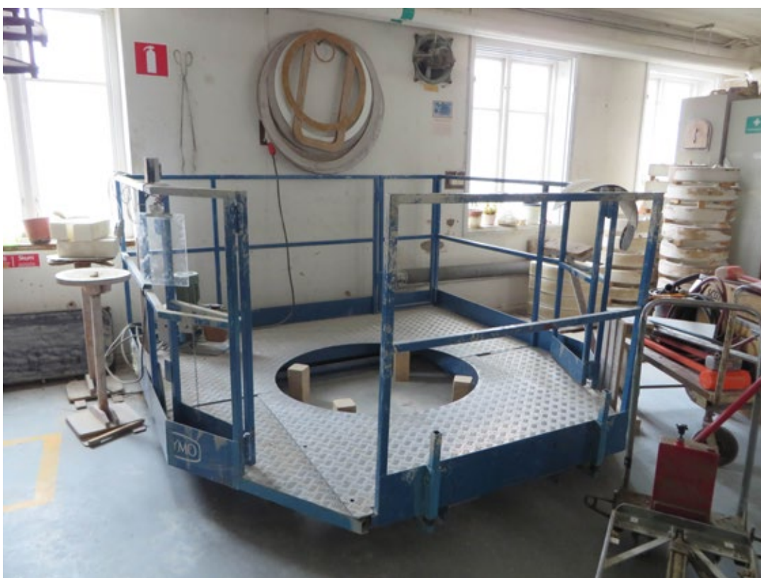
Ett modernt lyftbord, som gör det lättare att komma åt de övre delarna av degeln, särskilt när en snabeldegel ska byggas.
