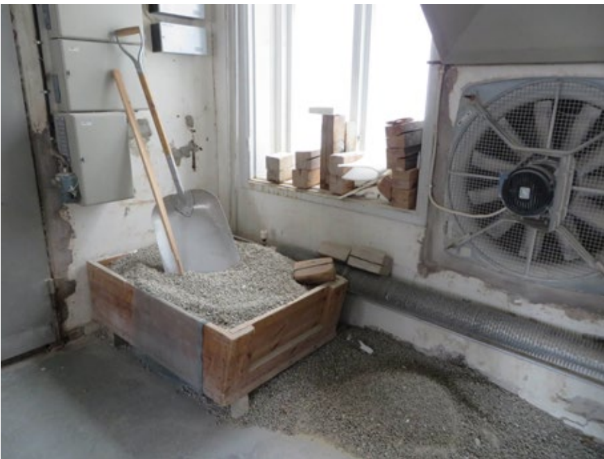
Grus används att lägga under deglarna så att de inte fastnar.
