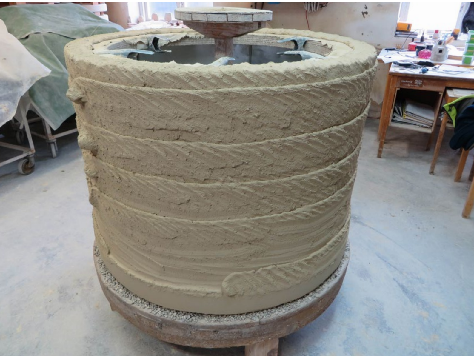
Den påbörjade degeln tummas upp för hand i 10 lager, enligt den engelska metod som lärdes ut här av en engelsman, Mr Totel, 1947. Arbetet måste göras i ett svep, och tar 9 timmar för en ensam man.
