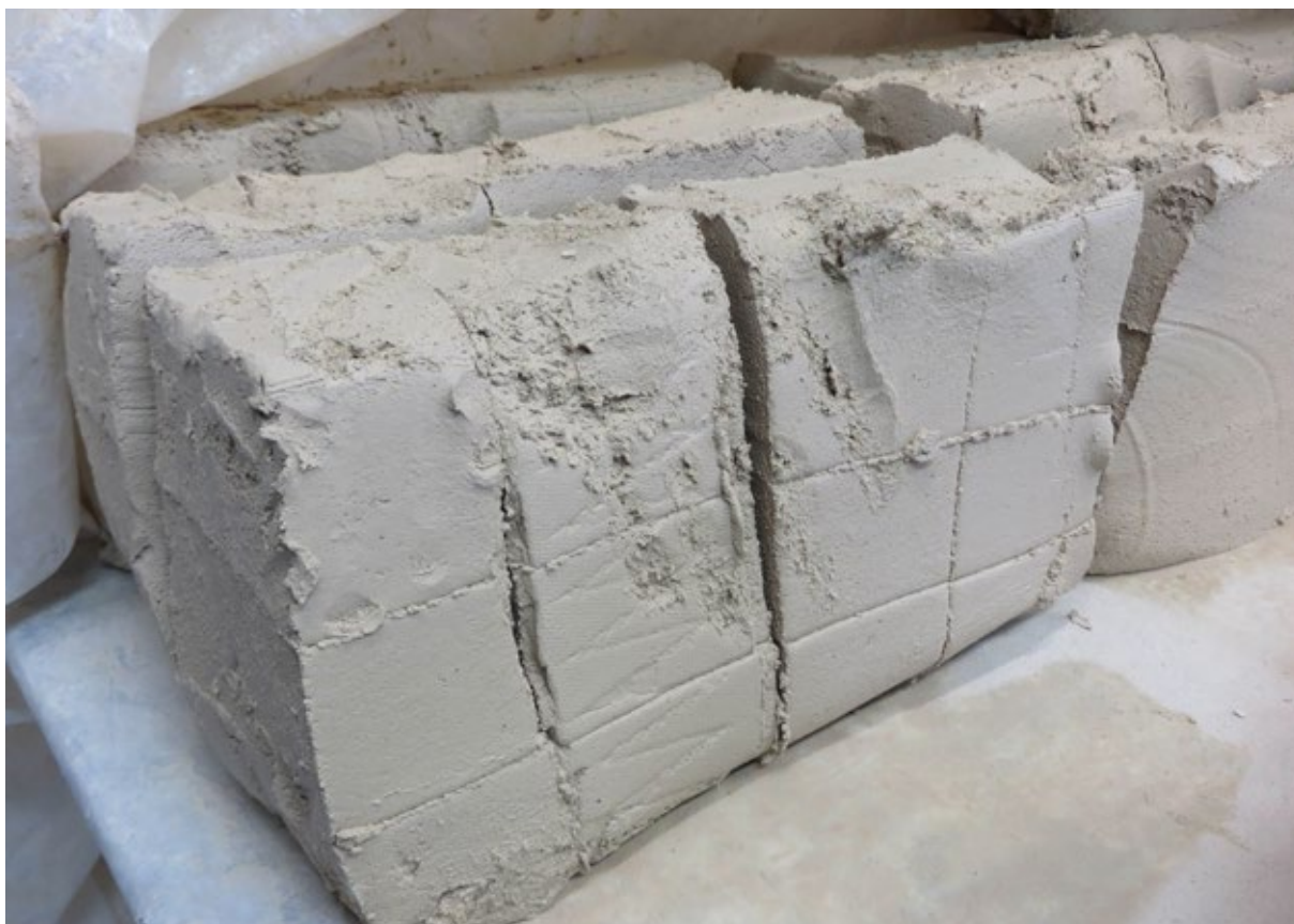
Leran skärs slutligen i kvadratiska bitar, där varje bit är en lagom handfull, innan den börjar användas.
