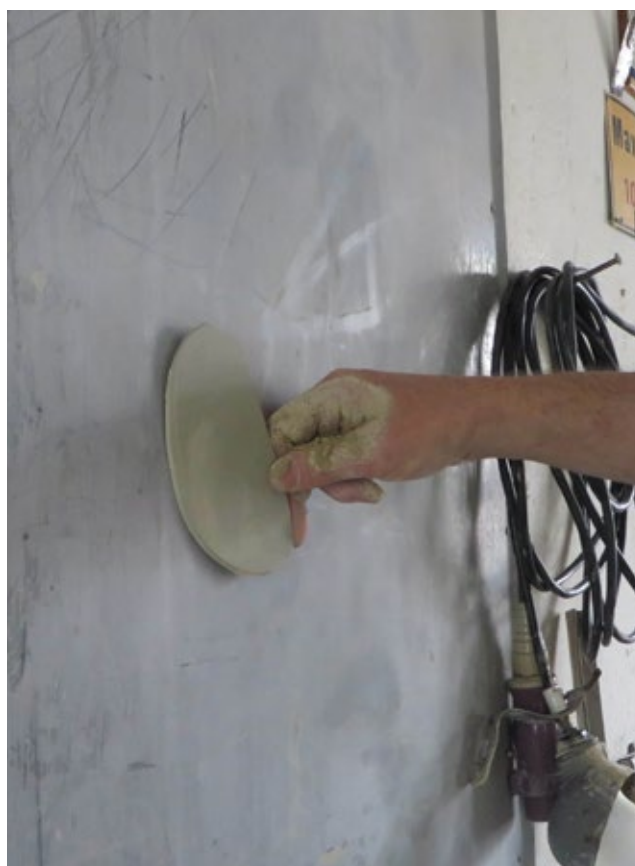
Olika mallar används som riklinje för att få önskade mått, som varierar mellan olika glasbruk. Ett mått är uppritat på väggen.
