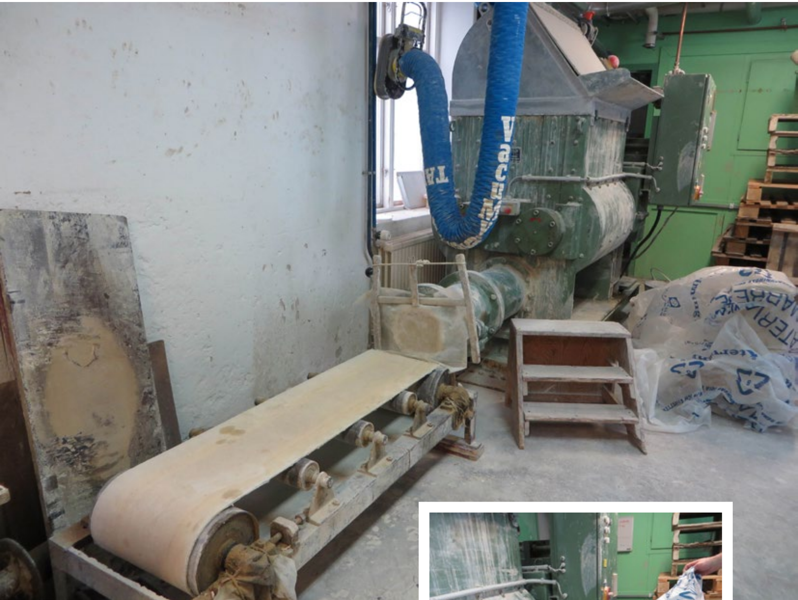
Lerkvarn. Leran trycks ut i fyrkantiga strängar, som förvaras på pall i sk stöpor.
