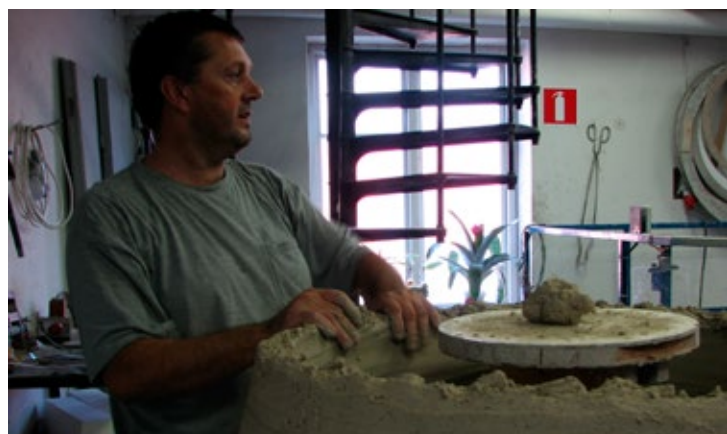
Zvonko Kulianac arbetar med en degel 2006. På väggen hänger en lång tång som kan användas ifall man tappar någon trasa eller kniv i degeln när den är nästan klar.
