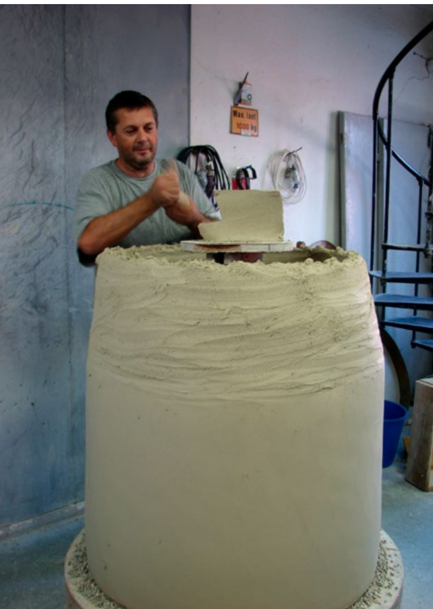
Zvonko Kulianac arbetar med en degel 2006. På väggen hänger en lång tång som kan användas ifall man tappar någon trasa eller kniv i degeln när den är nästan klar.
