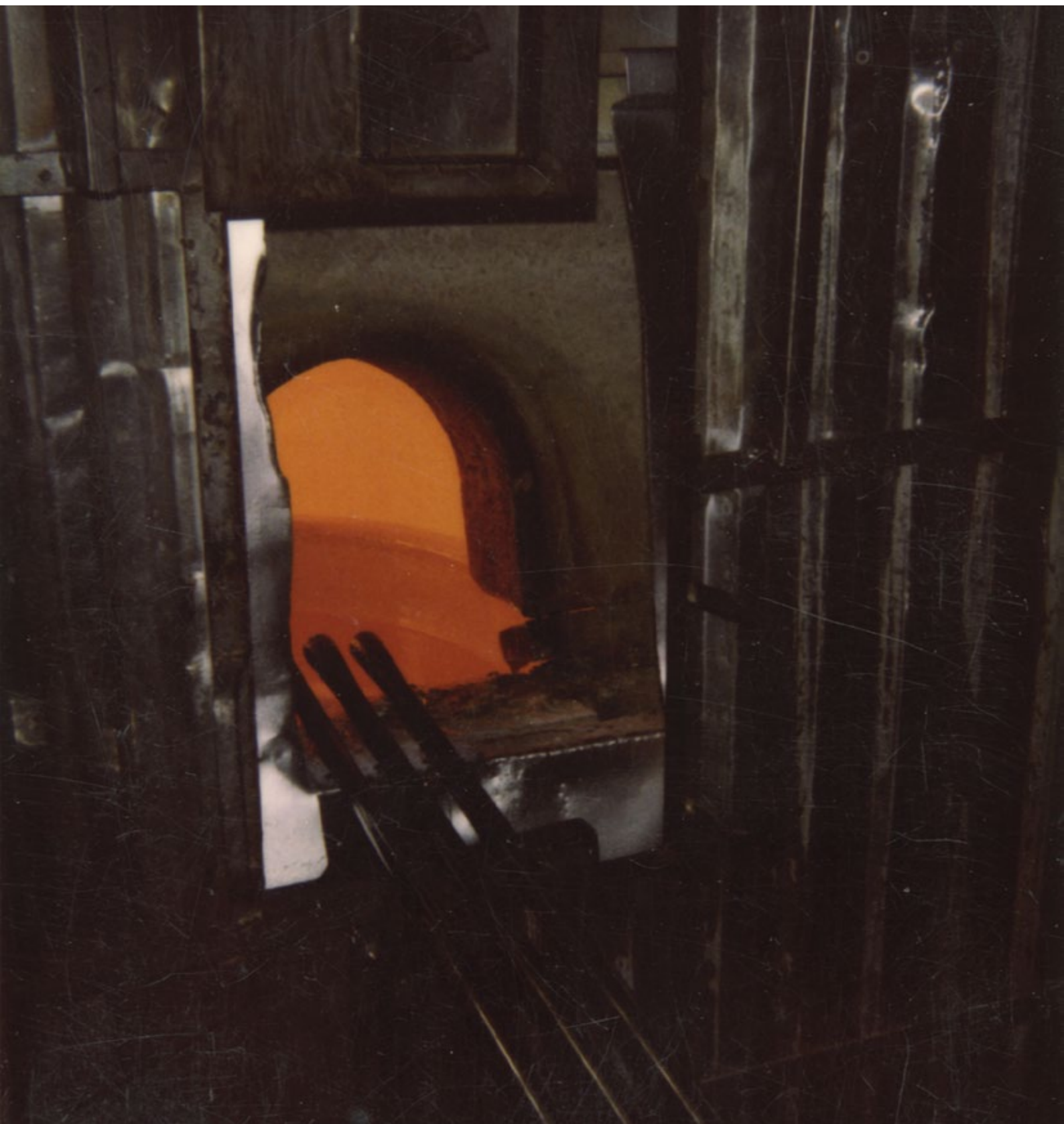
Degeln utsätts för stora påfrestningar i glasugnen, där glasmassan hettas upp till nästan 1500 grader. Foto: Peter Meinking/Per-Eric Deckert.
