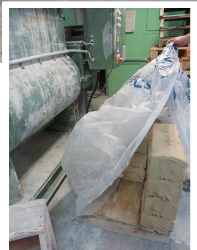
Lerkvarn. Leran trycks ut i fyrkantiga strängar, som förvaras på pall i sk stöpor.
