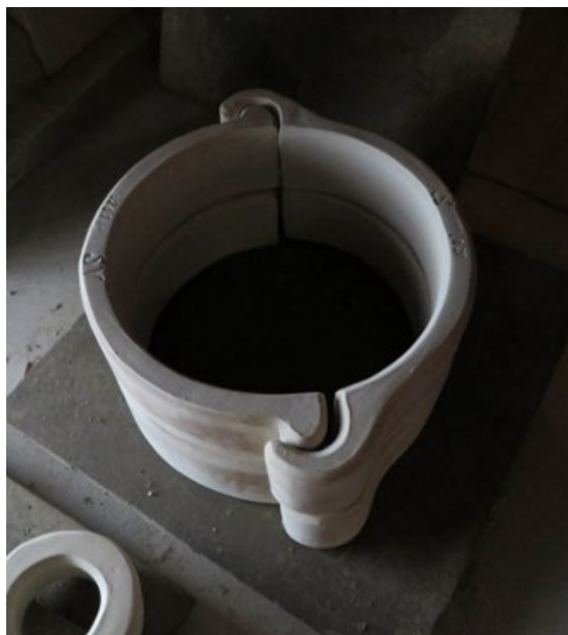
En öppningsbar så kallad knäppring är lättare att lägga i degeln, men fungerar inte lika bra.
