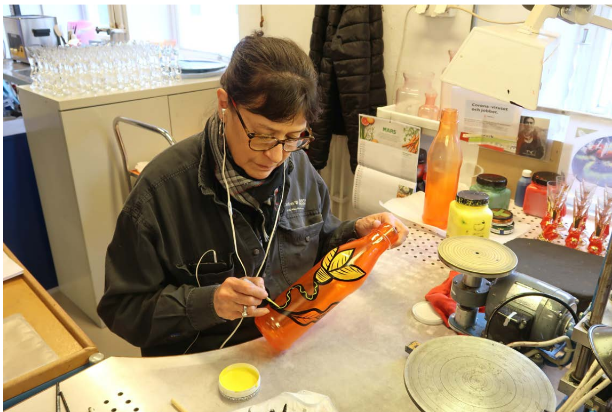
Målning med pensel på fri hand. Glasmålaren håller i glaset och lutar det till önskvärd vinkel.
