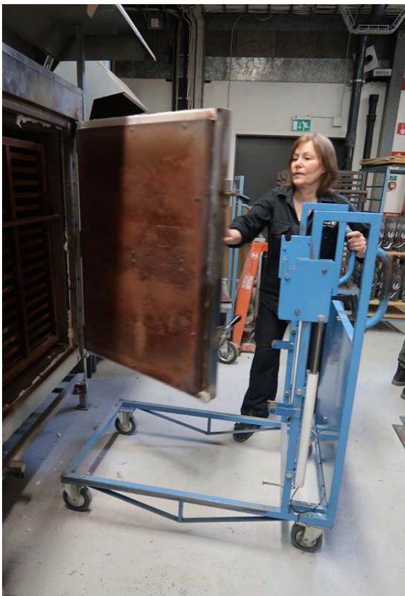
Det färdigmålade glasets körs manuellt på små vagnar mellan måleriet och den lokal där ugnarna finns, här av Diana Valle och Susanne Sjödin. Bilderna visar hur en ugn i Kosta våren 2020 töms och packas med nytt glas som ska brännas.
