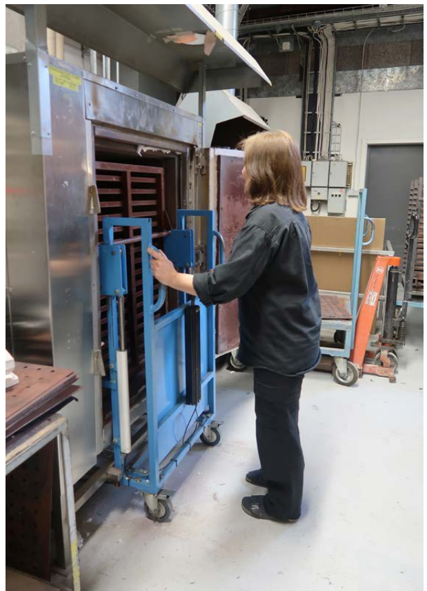
Det färdigmålade glasets körs manuellt på små vagnar mellan måleriet och den lokal där ugnarna finns, här av Diana Valle och Susanne Sjödin. Bilderna visar hur en ugn i Kosta våren 2020 töms och packas med nytt glas som ska brännas.
