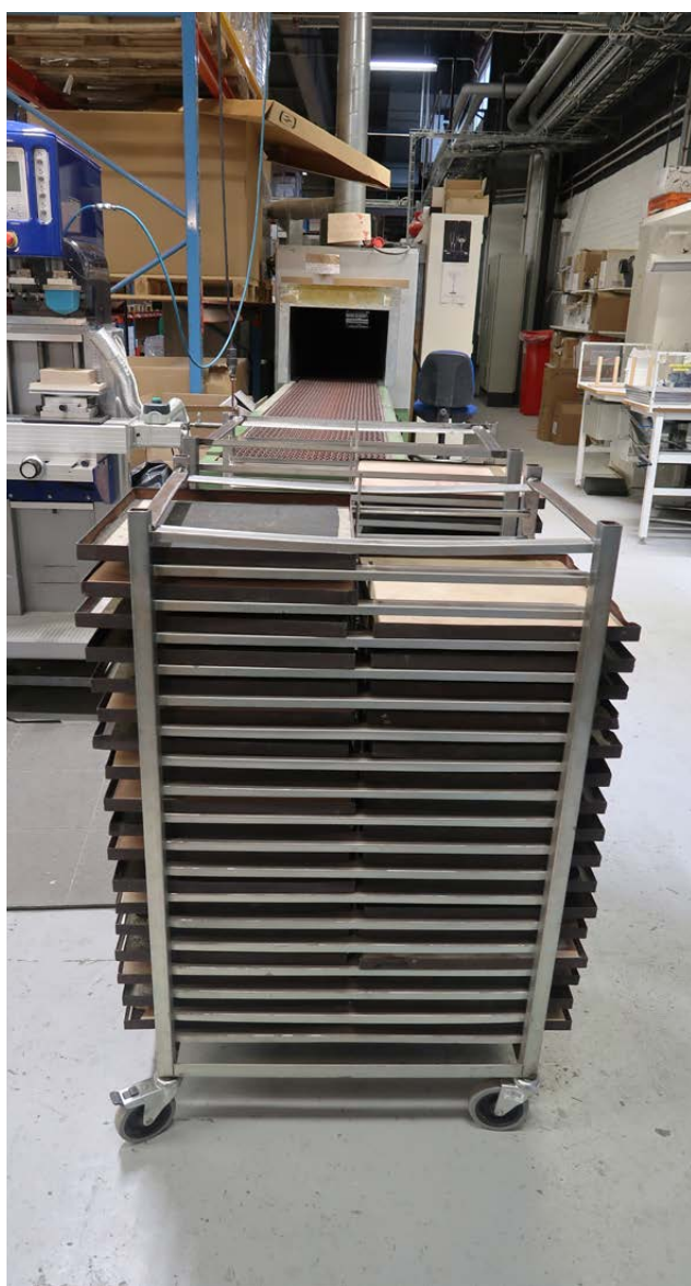
Ställ med plåtar som används att packa glas som ska brännas i ugnen.
