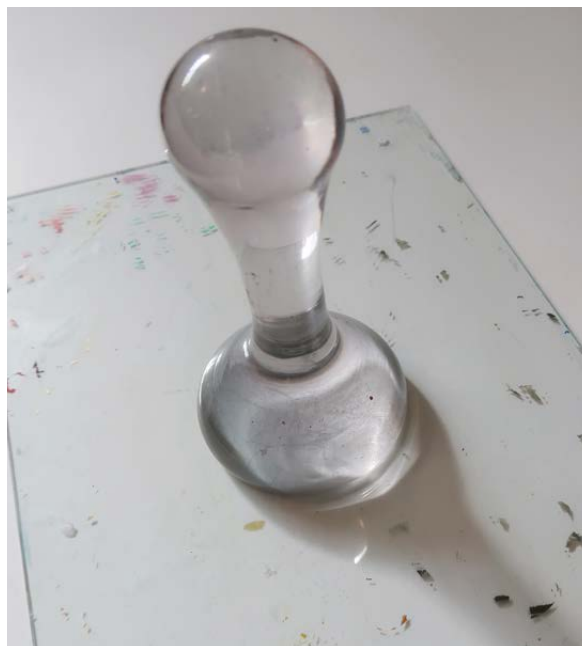
En stöt i glas användes för att "riva" färgen mot en slät yta, t.ex. en glasskiva. Stötens botten är mattad eller syrad. Den skulle inte vara för blank. Från Cecilia Almqvists privata måleri.
