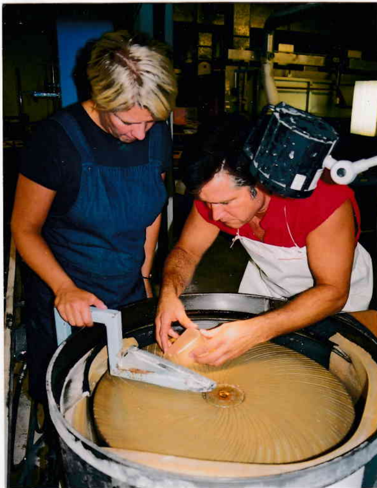
Planslipning av glasets hela sida för att få fram kontraster med hjälp av smala facetter!..
